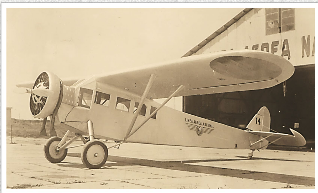
Avión Fairchild FC-2 "LAN 14" de la Línea Aérea Nacional perteneciente a la FAN. Motor Wasp de 450 H.P., que permitía una velocidad crucero de 200 kilómetros por hora. (Cabeza de serie de seis aparatos construidos en Chile) Foto gentileza del MNAE.
