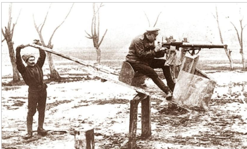
Rudimentario simulador de combate no identificado para artillero de a bordo probablemente ruso empleado durante la Primera Guerra Mundial
