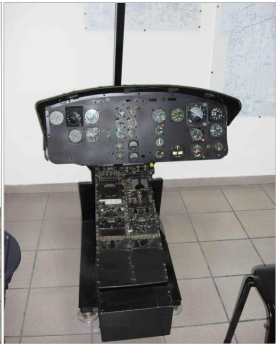
Mock-Up de helicóptero Bell UH-1H utilizado por la Escuela de Aviación del Ejército Argentino
