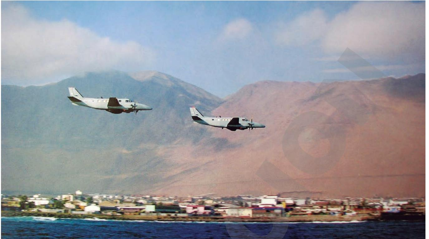
Una formación de aviones Petrel del Grupo de Aviación No. 2, volando sobre un sector costero del Norte de Chile con su nuevo esquema de baja visibilidad. Se puede observar las diferencias de forma y tamaño de los radomos entre el Petrel Beta (No. 301, adelante) y el Alfa (No. 304, atrás). Fuente: Fuerza Aérea de Chile.
