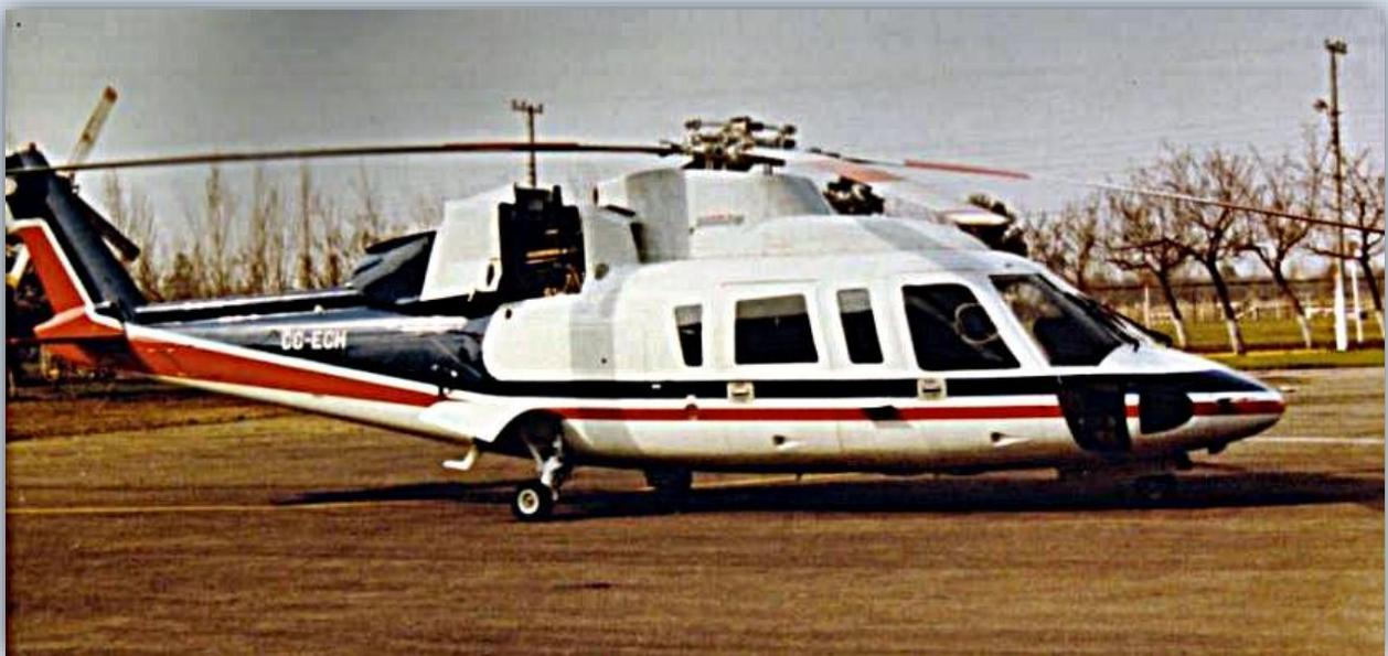
*Estacionado después de un vuelo, se pueden ver las capotas de las turbinas abiertas.*
