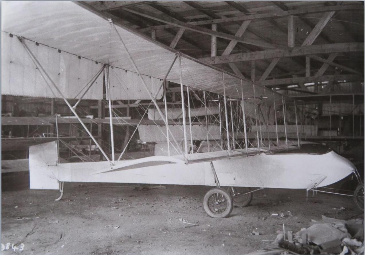
***Biplano 1912 configuración propulsora en el taller de la firma***
