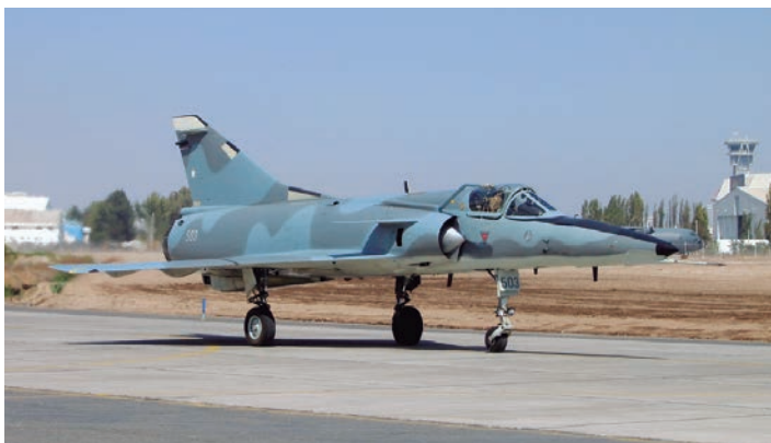
La flota de aviones Mirage 50 también fue modificada, recibiendo extensivos cambios aerodinámicos y de nuevas capacidades tecnológicas. Los aviones fueron denominados Mirage 50CN/DCN Pantera. Colección Andrés Contador K.
