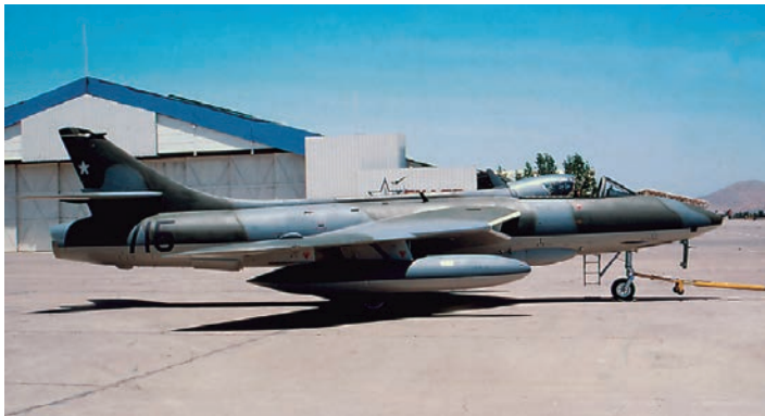
La flota de aviones Hunter fue la primera en ser modificada localmente para mejorar sus capacidades de combate con la aplicación del Programa Águila, que les proveía de un efectivo RWCN/ECM y capacidad para disparar el misil Shafrir II. Colección MNAE.
