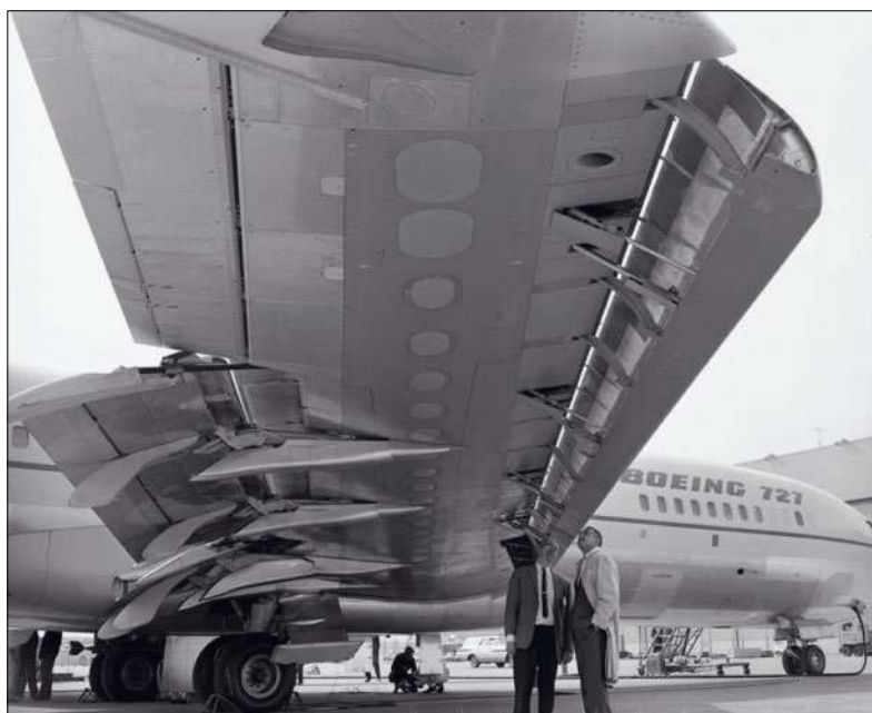
L'incroyable aile du 727 et ses dispositifs hypersustentateurs, en bord d'attaque comme en bord de fuite, permirent à l'avion d'atteindre les performances attendues.
