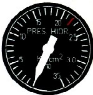
INDICADOR PRESION HIDRAULICA
