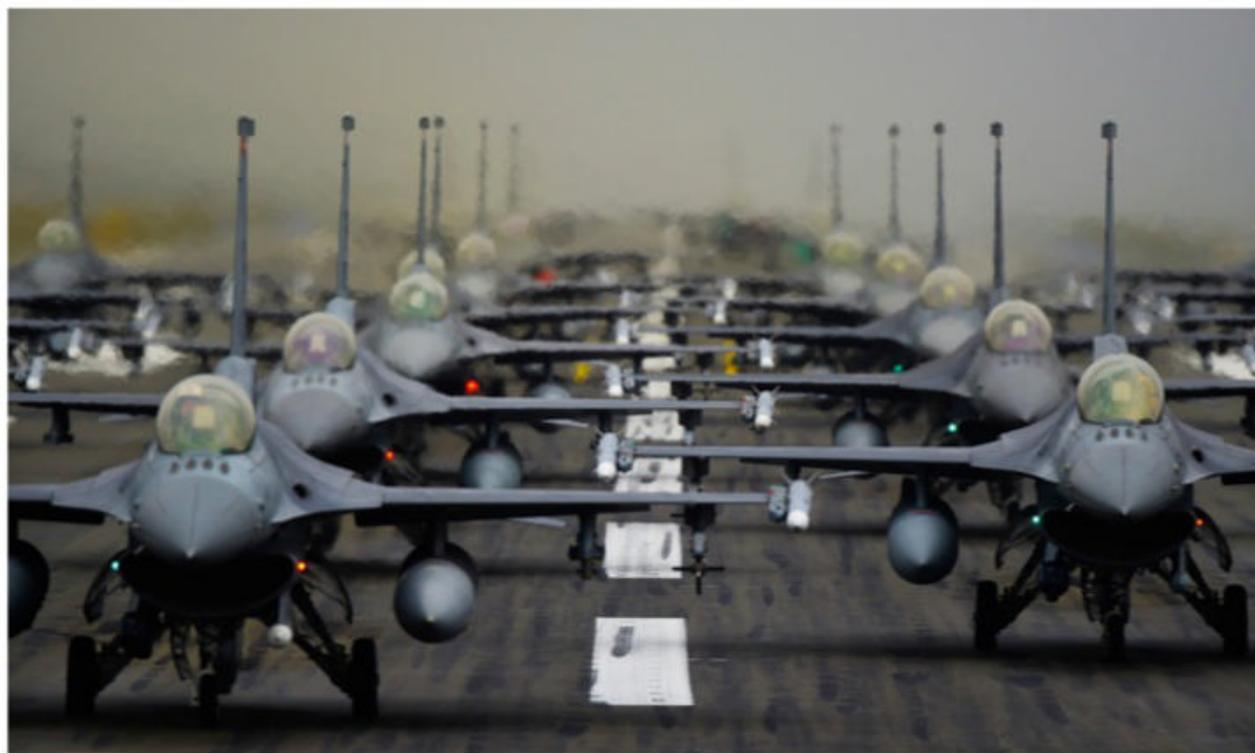
Lockheed) em 1993 e recebeu uma série de melhorias. A USAF utiliza atualmente apenas os F-16C/D Block 40-42 e Block 50-52, embora versões mais avançadas sejam usadas por forças aéreas aliadas. Usualmente, o F-16C pode transportar dois mísseis AIM-9 Sidewinder, dois AIM-120 AMRAAM, além de contar com um canhão M61A1 de 20 milímetros. O caça ainda pode ser equipado com diversas armas, inclusive
