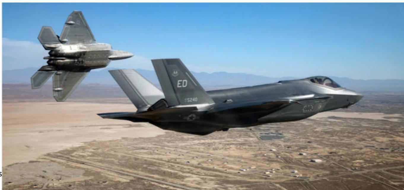
agrega uma série de tecnologias avançadas, sendo atualmente o mais tecnológico caça em serviço no mundo. O modelo tem como armamento padrão um canhão GAU-22/A de 25 milímetros e pode ser armado com diversos mísseis e bombas, em quatro compartimentos internos e seis pontos duros sob as asas. Recentemente, a USAF iniciou a validação para uso no F-35 da bomba nuclear tática B61 Mod 12.
