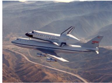
Dois 747-100 foram adaptados pela NASA para transportar o Ônibus Espacial entre a Califórnia e a base de lançamentos do Cabo Canaveral, na Flórida. Com o veículo orbital montado em cima, o 747 fazia quatro escalas para conseguir cruzar os Estados Unidos.
