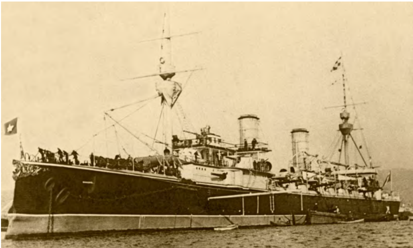
▲ Crucero Esmeralda , construido en 1895 con casco de acero forrado en madera y cobre. Fotografía ca. 1886. Colección Archivo y Biblioteca Histórica de la Armada, Valparaíso.
