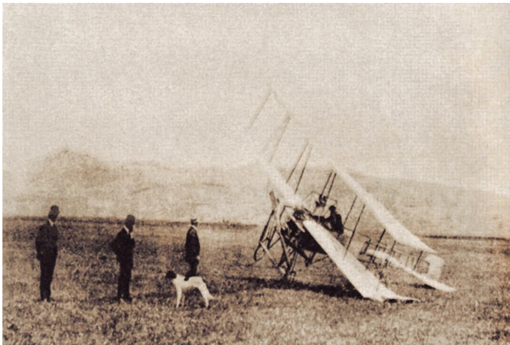
Figura 2. Aeronave Blériot acondicionada con un segundo plano por José Cicerón Castillo, en su intento por efectuar un vuelo a la altura de Bogotá (junio de 1911).
