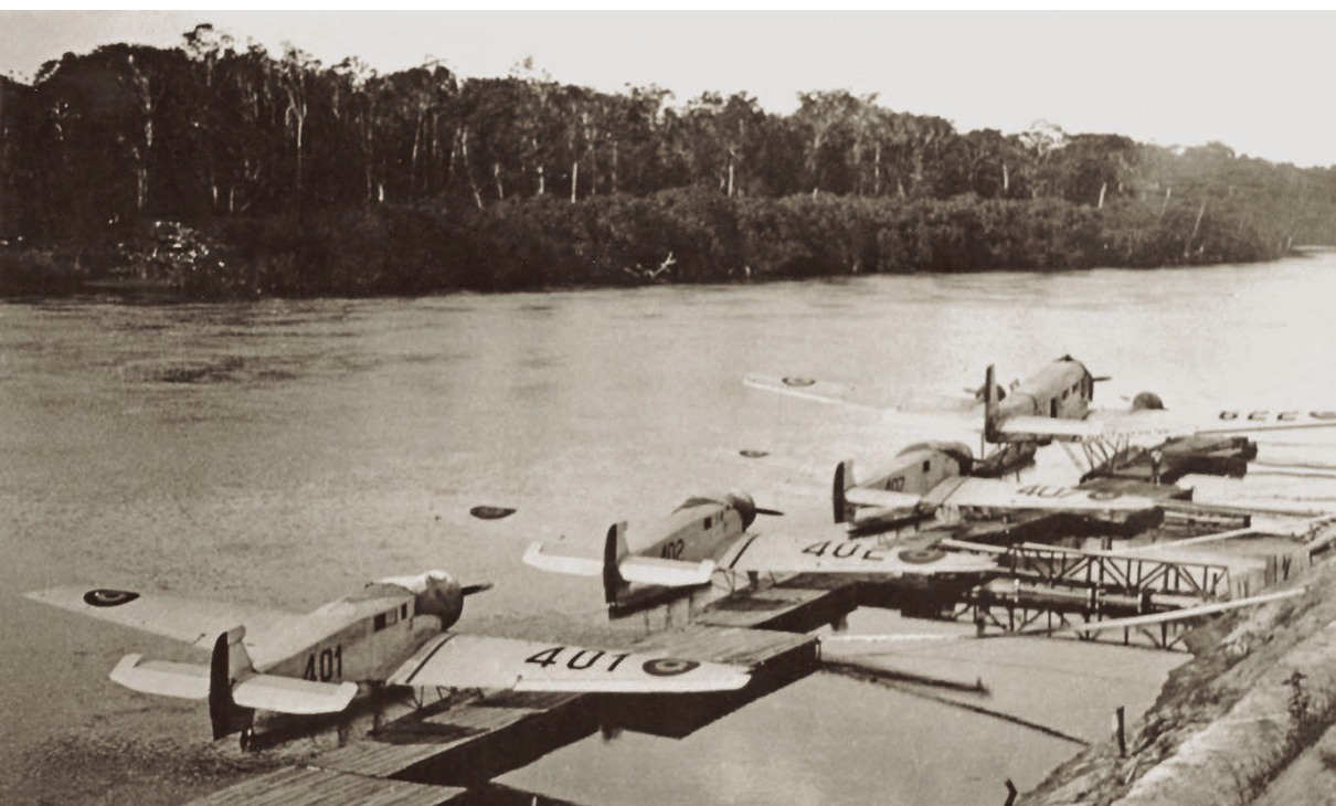
Figura 49. Tres aeronaves Junker W 34 y una JU 52, todas de fabricación alemana, adecuadas con flotadores para las operaciones como hidroavión durante el conflicto colombo-peruano (Puerto Boy, río Caquetá, 1933).
