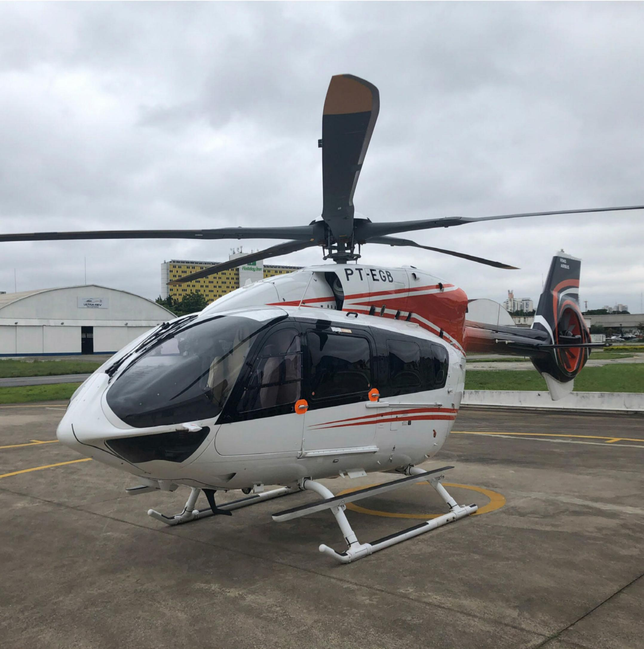
posiciones opuestas no se toquen. El tiempo cerrado requiere atención, pero no impide el vuelo. Dejamos el suelo bajo poquita lluvia y mucha niebla. En vuelo, el nuevo diseño del rotor principal, sin rodamientos, muestra eficiencia. Además de facilitar el mantenimiento, suaviza las vibraciones, favoreciendo el confort a bordo.
