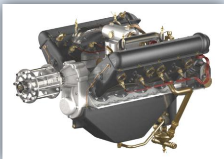
Motor Hispano Suiza V8 como el equipó el Blériot-SPAD XIII que tuvo en servicio la Aviación del Ejército de Uruguay a partir de 1920 25
