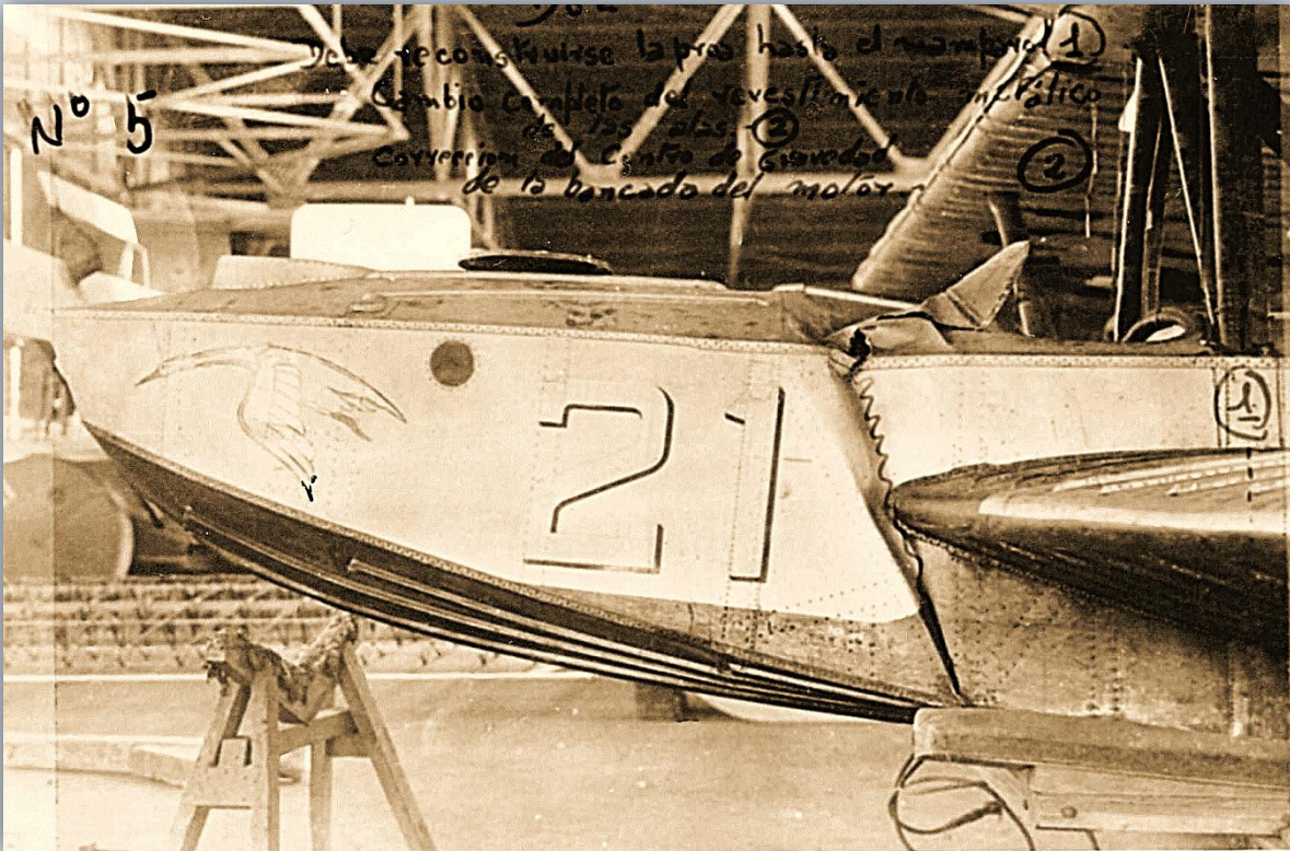
Fotografía del sumario que indica los trabajos a realizar tras el accidente. Entre ellas señala que debía reconstruirse la proa hasta la mampara con el N°1; el cambio completo del revestimiento metálico de las alas. N°2 Corrección del centro de gravedad de la bancada del motor.
