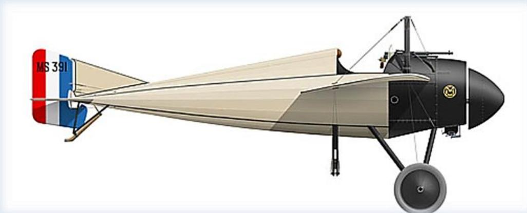
**Perfil del avión Morane-Saulnier tipo N, matrícula MS 391 que usara el Subteniente Juan Bielovucic, piloto de la Escuadrilla MS 26, entre el 28 de julio al 22 de octubre de 1915, sobre la zona de Dunkerque. Su avión estaba equipado de deflectores que protegían las palas de las hélices de las balas que podían dañarla. (Diseño de Alexander Kazakov. [http://albindenis.free.fr/Site\\_escadrille/escadrille026.htm](http://albindenis.free.fr/Site_escadrille/escadrille026.htm))**
