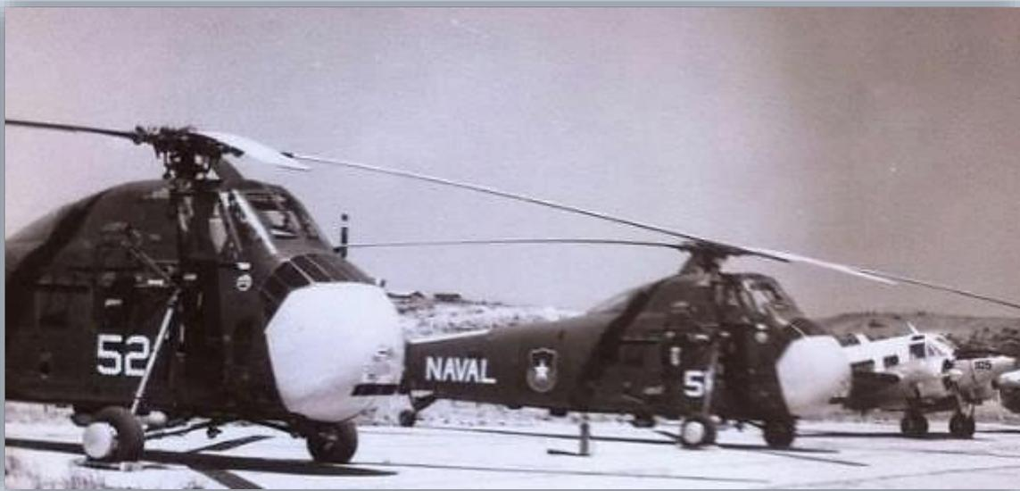
*Naval 51 y 52 con su sistema de flotación instalado.*
