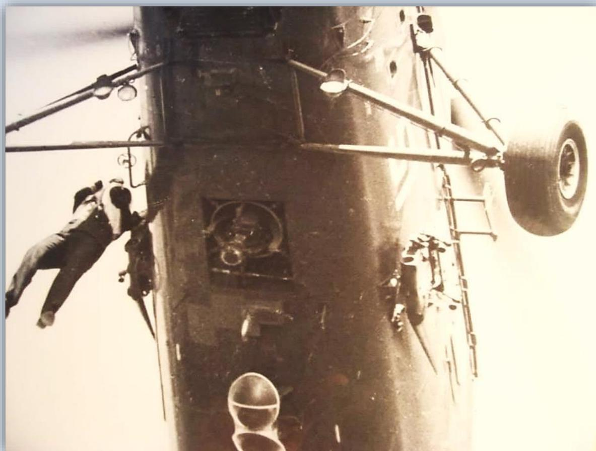
*En esta imagen se puede apreciar en la parte inferior del fuselaje el domo del sonar de profundidad variable, además el uso de la grúa de rescate.*
