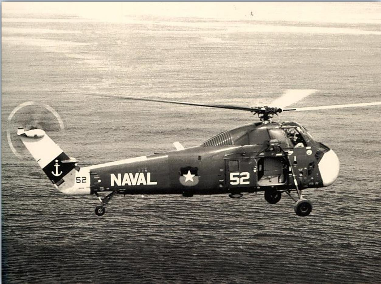
Los SH-34J estaban equipados con un solo motor radial recíproco marca Wright, modelo R-1820, de 1525 HP al despegue y de nueve cilindros enfriados por aire; empleaba bencina de 115/145 octanos. Sus estanques tenían una capacidad de 307 galones. Una autonomía de 4 horas en vuelo crucero entre 80 y 90 nudos. En operaciones antisubmarinas, con un 50 % de vuelo en la posición de vuelo estacionario, su autonomía se veía reducida a dos horas.
