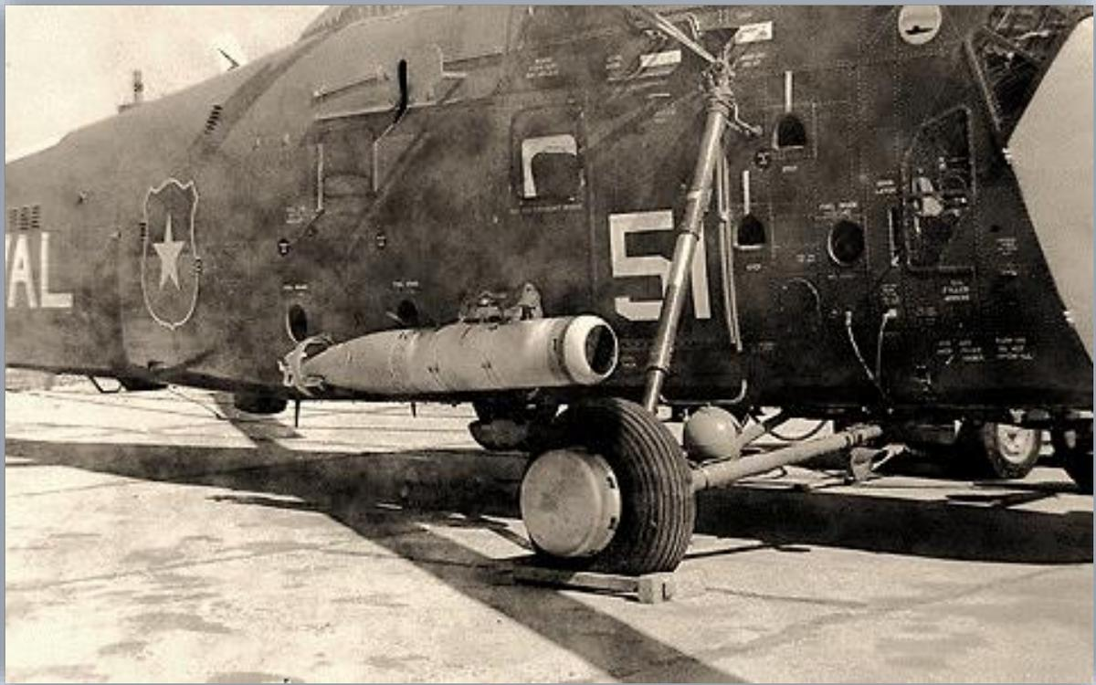
*El helicóptero podía llevar dos torpedos MK43 (520 libras), dos minas MK-24 (1396 libras) o una bomba de profundidad MK-101.*
