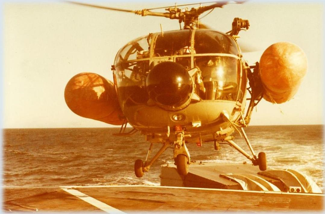
*Helicóptero Alouette con su sistema de flotación de emergencia activado.*
