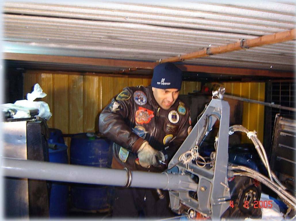
*Personal de Mantenimiento del Escuadrón de Helicópteros de Ataque, durante la noche del 3 y madrugada del 4 de agosto de 2005, cambiaron el cable dañado de una grúa de rescate de uno de los helicópteros Cougar.*
